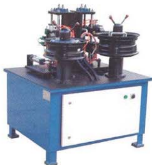
دستگاه آزمون لقی محوری و شعاعی رینگ خودرو
